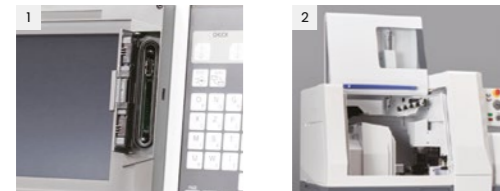
Umrüsten von Lang- auf Kurzdreher und umgekehrt (durch Montage / Demontage der Führungsbuchse)
