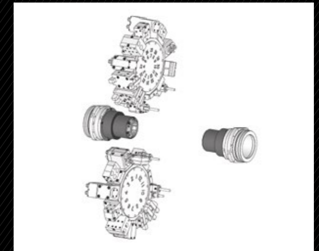
Zwei Revolverköpfe mit je 12 Stationen. Zwei Spindeln mit einer Spindeldrehzahl von je 6.000 min -1 .
